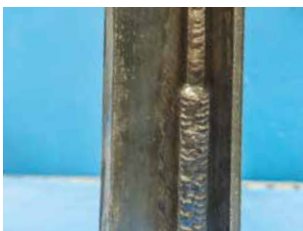
Многопроходно заваряване - вертикално нагоре
