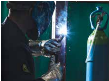
МАГ заваряване на въглеродни стомани
